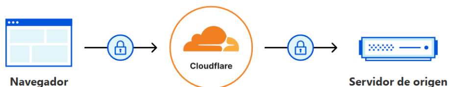
Figura 35: Comunicación cliente servidor con Cloudflare, modo cifrado completo. Fuente: Elaboración propia.
