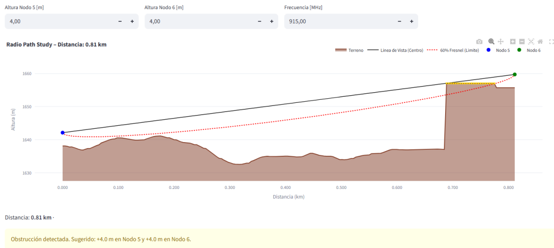
Figura 5.4: Perfil de elevación y verificación de despeje geométrico para el enlace crítico 5-6. Fuente: aplicación web desarrollada, módulo 3.
