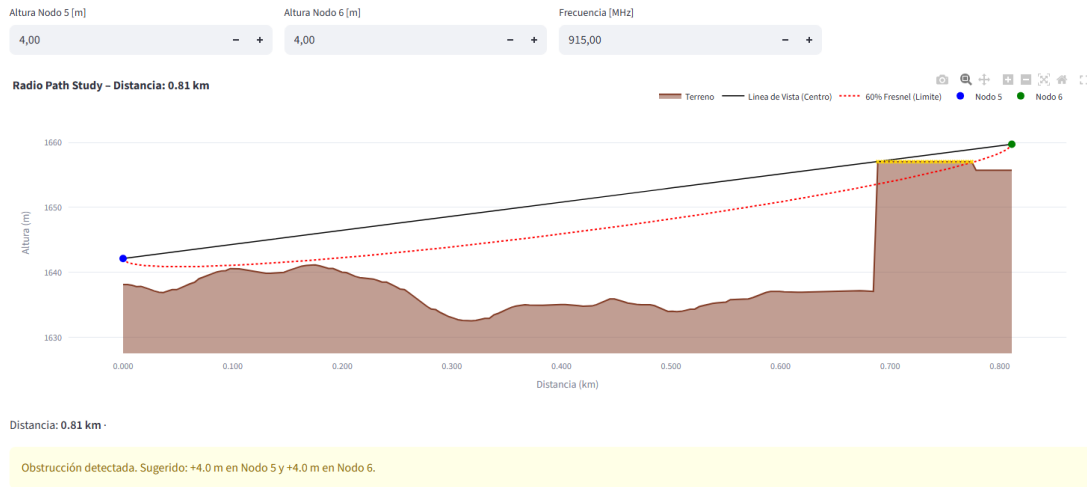
Figura A.9: Panel de Radio Path con perfil de terreno, zona de Fresnel y sugerencia de altura.
