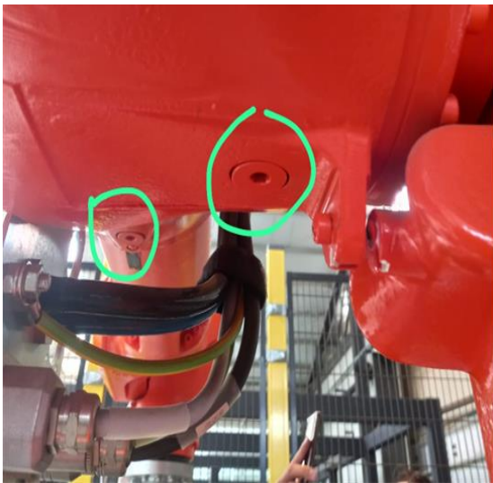
Figura 3 -13 Puntos de acceso para aceite ALR 150 Fuente: Elaboración propia
