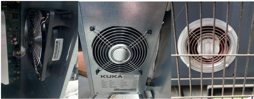
Figura 3 - 18 Filtros E2 de unidad de control KR C4 Fuente: Elaboración propia
