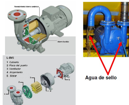
Figura 1.14: Bomba de vacío
