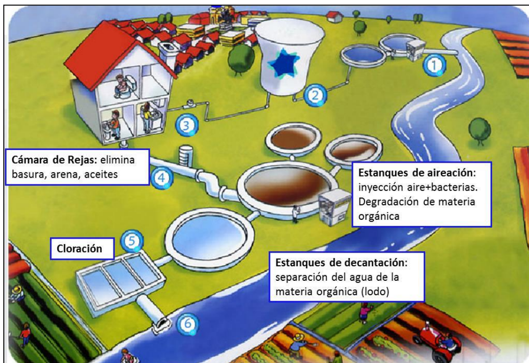
Figura 2-6 Esquema simplificado del proceso de tratamiento de aguas servidas.
