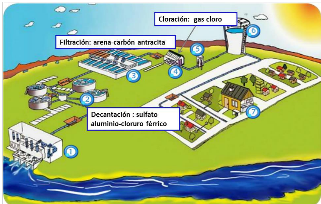
Figura 2-5 Esquema simplificado del proceso de producción de agua potable.
