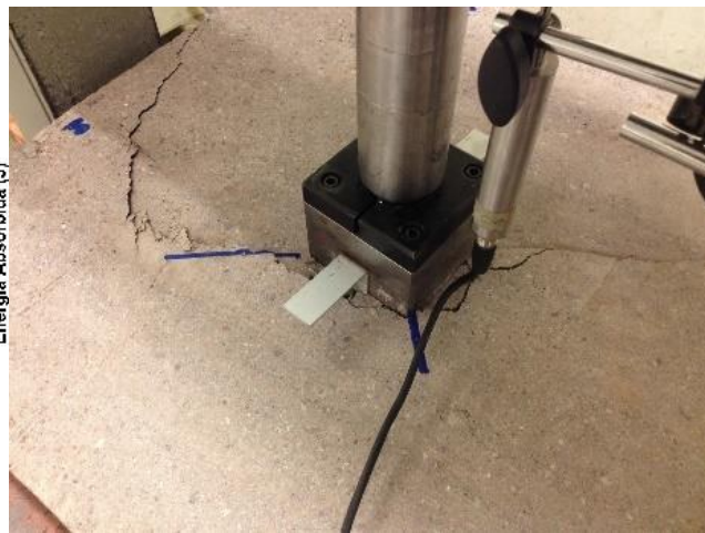
Ilustración 4 Falla por cortante por punzonamiento observada en paneles con cuantías de fibras medias y altas
