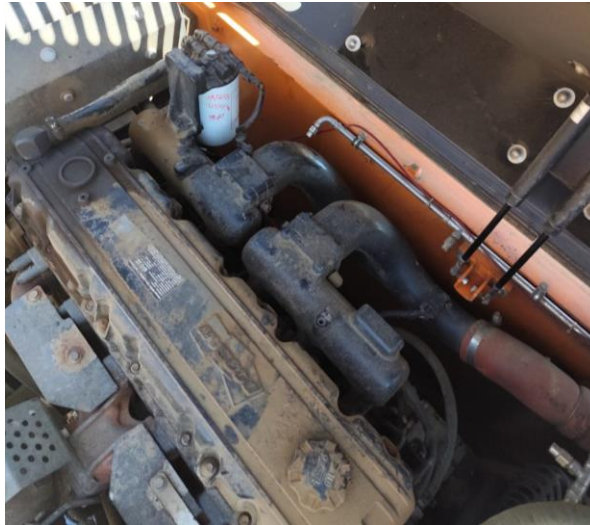
Figura 1 38: Respiradero de motor con fuga.
