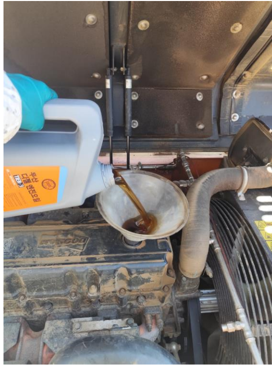
Figura 1 31: Llenado de aceite de motor.
