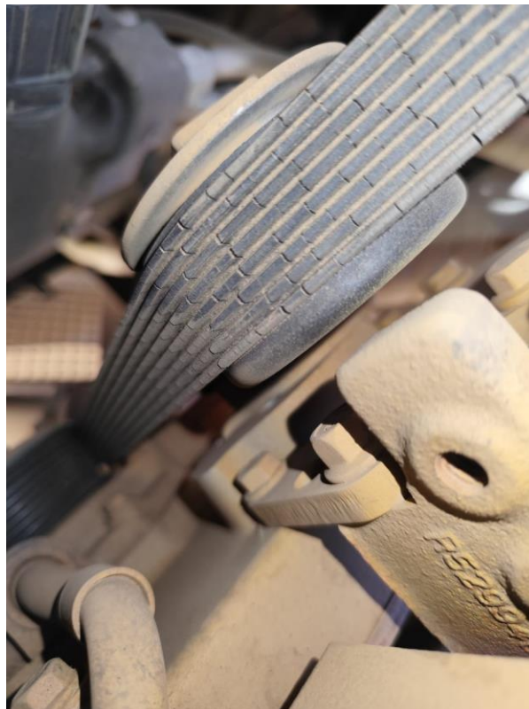
Figura 1 37: Correa de distribución desgastada.
