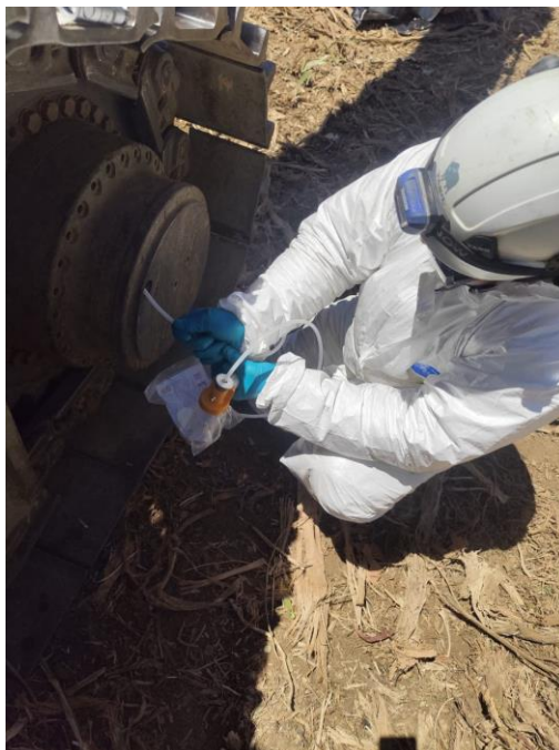
Figura 1 19: Ingreso de sonda a conjunto reductor.
