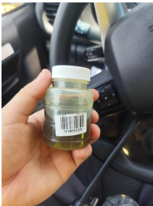
Figura 1 20: Toma de muestra de aceite.
