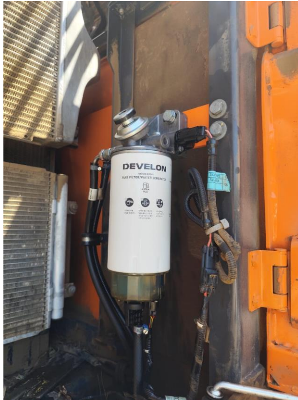
Figura 1 28: Filtro decantador de agua.
