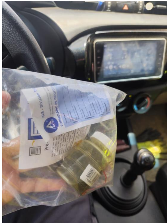
Figura 1 21: Correcta aislación de toma de muestra de aceite.
