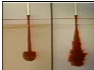
Figura 4.3: inyección de tinta en agua. A la izquierda un flujo laminar y a la derecha un flujo turbulento. Fuente: referencia [33], capítulo de turbulencia.
