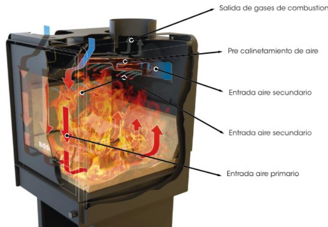
Figura 19: Esquema del sistema de doble combustión Spirit 380. [Fuente: Manual de uso Spirit 380.]
