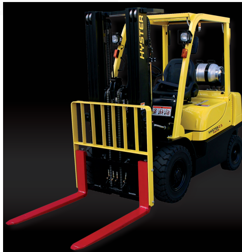
Figura 4.10: Grúa horquilla a gas. Fuente: Hyster, Brochure H1.5-3.5TX. [ http://www.hyster.com ]
