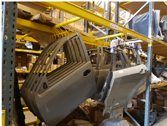
Figura 5.1: Solución de almacenamiento de puertas. Fuente: CD Repuestos casa matriz de la empresa en estudio.
