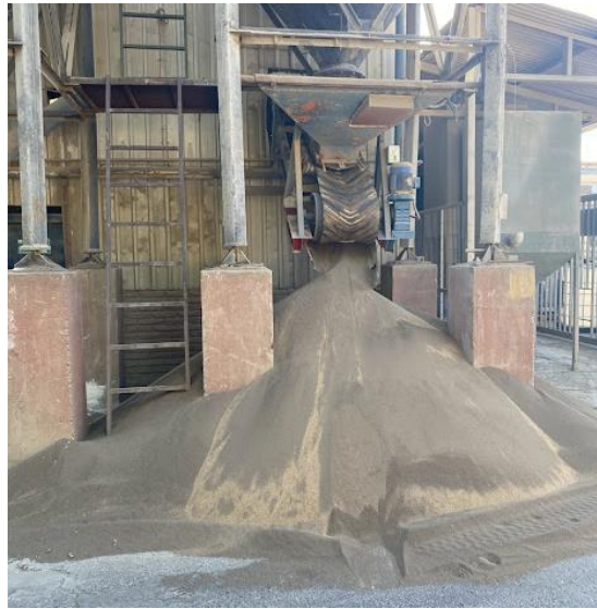
Figura 10: Acumulación de pérdida de arena por correa transportadora.
