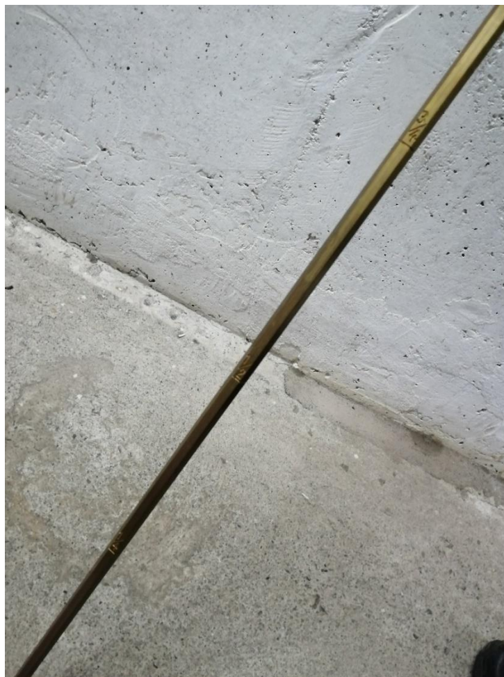
Ilustración 1-16: Vara graduada utilizada para la medición de estanques diésel.
