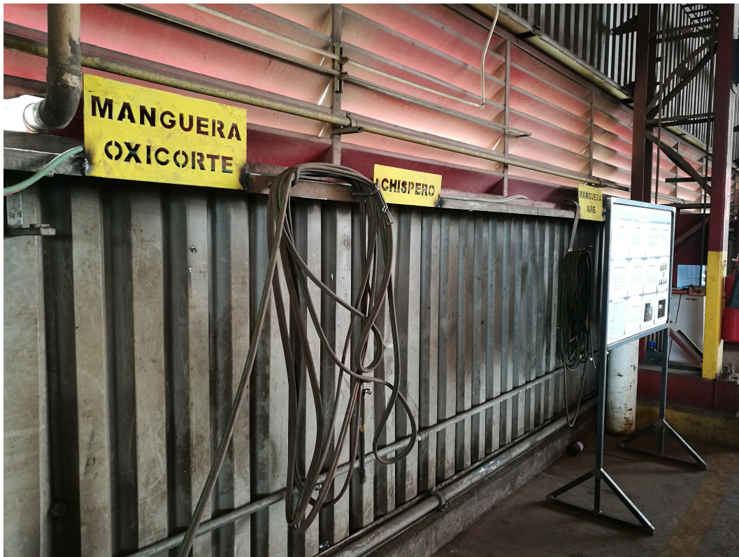
Figura 4.13: Letrero de demarcación para mangueras. Fuente: Elaboración propia.
