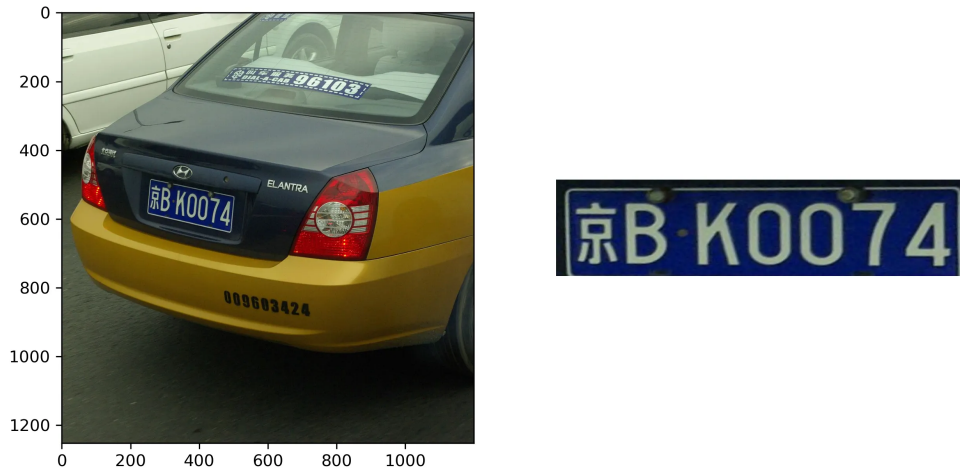
Figure 4.6: Ejemplo procesado por la red IWPODNet, donde se muestra que el modelo es capaz de obtener la patente, a pesar del ángulo en el que ésta se encuentra y de las partes que también podrían ser consideradas patentes.
