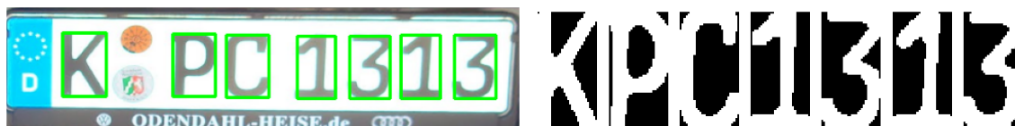
Figure 5.2: Pasos necesarios realizados con OpenCV para identificar y extraer los caracteres de la patente.
