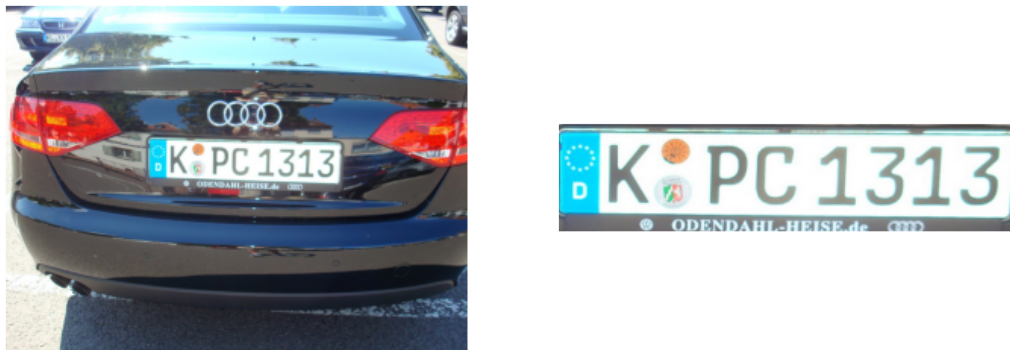
Figure 5.1: Extracción de la patente en un ejemplo, utilizando el modelo IWPODNet.
