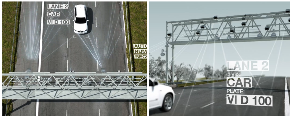
Figure 2.4: Ejemplo de funcionamiento de PoliScan Surveillance.
