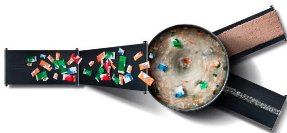
Figura 4.3: Prototipo de Hidropulper para la separación de papel y polialuminio.
