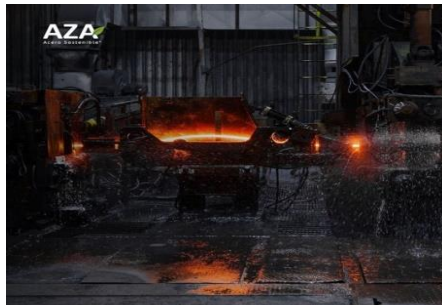
Ilustración 10: Producción de alambón y rollos en el tren de laminación.
