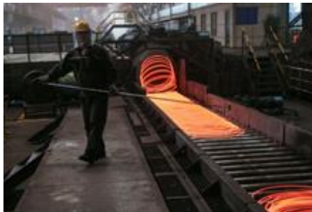
Ilustración 10: Producción de alambón y rollos en el tren de laminación.
