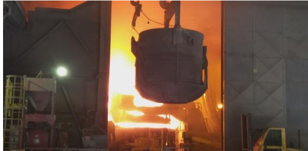
Ilustración 9: Traslado de cesta con chatarra al Horno Eléctrico, Acería.
