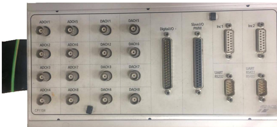
Figura 31 Panel de Conexiones dSPACE
