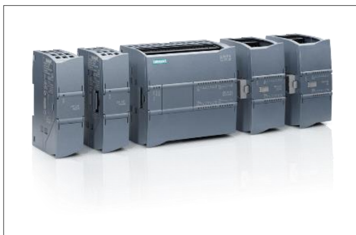
Figura 2-1. PLC Siemens S7 1200 conectado a varios módulos de expansión.
