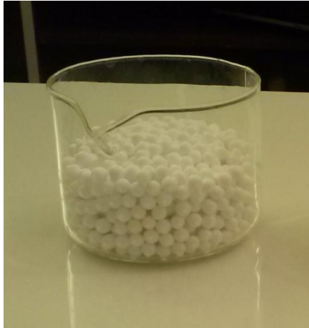
Figura 4.1: Esferas de Alúmina Utilizadas como Medio Poroso.
