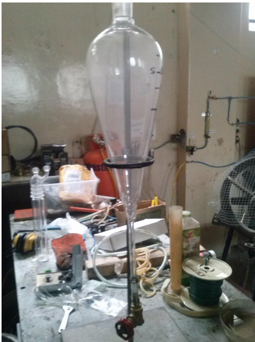
Figura D.4: Silo Sistema Catalítico con Catalizador Fluidizado.
