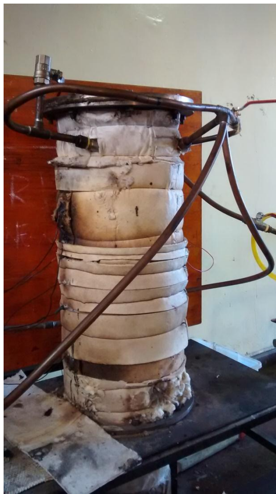
Figura B.2: Reactor de Medio Poroso Utilizado en la Investigación.
