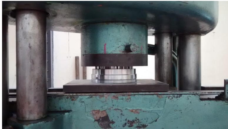
Figura 4.10: Prensa Hidráulica Comprimiendo el Catalizador.
