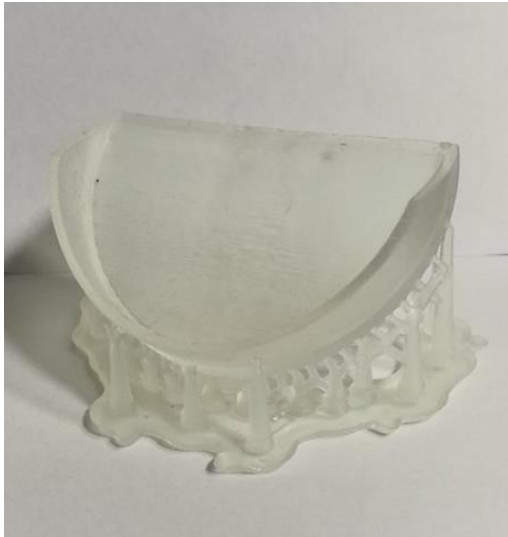
Imagen Anexo 3.1.1 - Molde inconcluso por falta de resina en el tanque.
