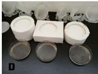
Imagen 5.1 – Proceso de generación de moldes de silicona. (A) Materiales necesarios para realizar mezcla del caucho. (B) Cámara de vacío utilizada en CB-DAL. (C) Proceso de extracción de aire al interior del molde. (D) Obtención de moldes de caucho y replicas.
