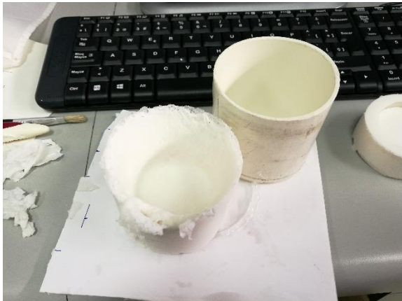
Imagen Anexo 3.3.1.2 - Molde deformado por la cámara de vacío por exceso de catalizador.
