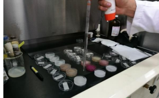
Imagen 5.4 – Uso de pipeta para verter mezclas en moldes.
