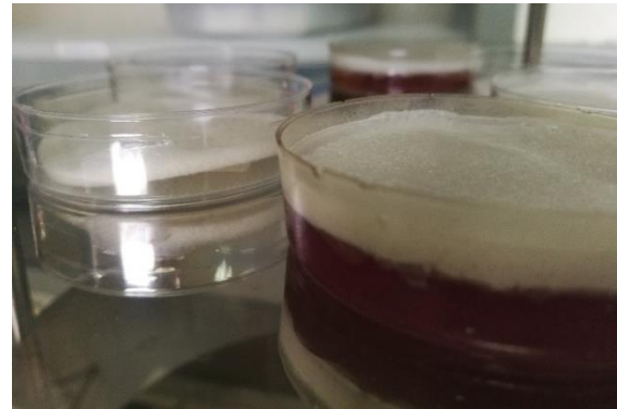
Imagen 5.5 – Resultado de scaffolds luego de liofilizar.
