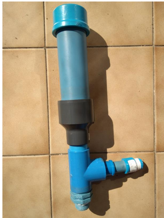
Figura 6.9 Componente cámara de aire ariete marino
