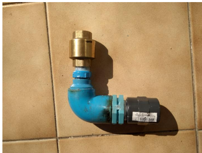
Figura 6.10 Componente válvula de choque ariete marino
