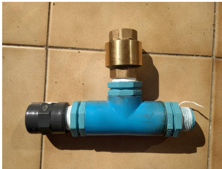
Figura 6.8 Componente ducto principal y válvula de retención ariete marino
