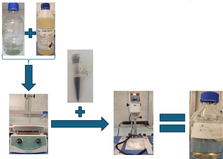
Figura 3.3. Proceso de sintetización de nanofluido aceite/ \text{NiCo}_2\text{O}_4
