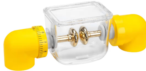
Figura 3.5. Celda sin agitador para muestras del BAUR DPA 75 C.
