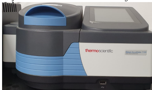
Figura 3.9. Espectrofotómetro utilizado en el ensayo de espectroscopía visible.
