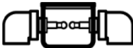
Figura 3.6. Celda con electrodos esféricos.
