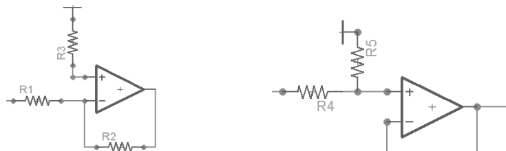
Figura 3. 23. Configuración Inversory no inversor respectivamente
