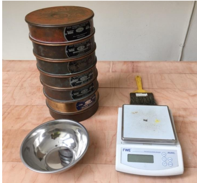
Figura 16: Elementos utilizados para el ensayo de tamizado.
