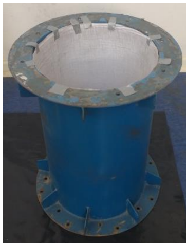
Figura 19: Silo cubierto de papel canson.
