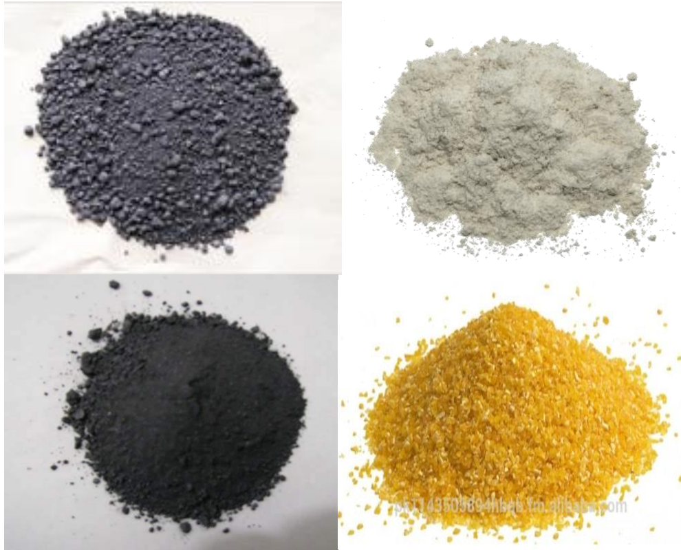
Figura 15: Sólidos a granel ensayados. De izquierda a derecha y de arriba hacia abajo: pre-concentrado de hierro, harina, concentrado de cobre y gritz de maíz.
