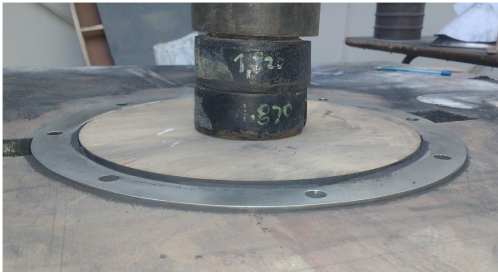
Figura 34: Ensayo de sobrecarga en tolva de 20° con concentrado de cobre.
