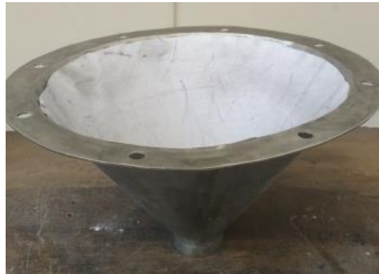
Figura 25: Tolva de 35° cubierta de papel canson.
