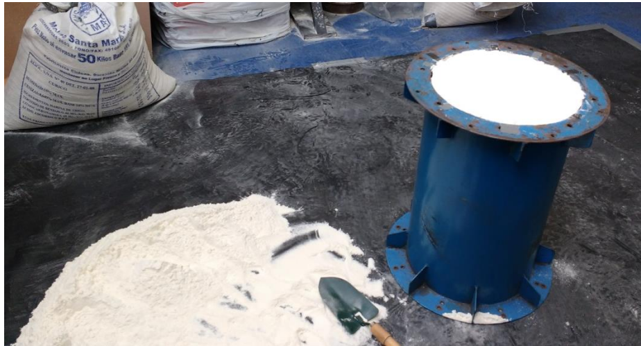
Figura 28: Ensayo de capacidad en silo Canson (297/481) con harina.
