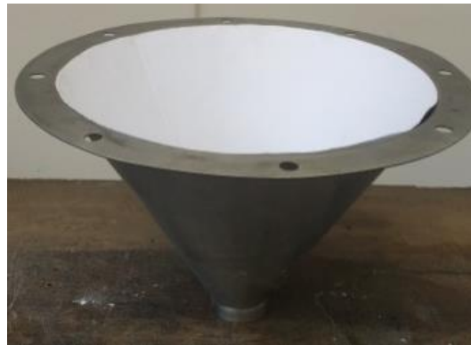
Figura 24: Tolva de 30° cubierta de papel canson.
