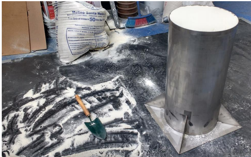
Figura 30: Ensayo de capacidad en silo SS (296/603) con harina.
