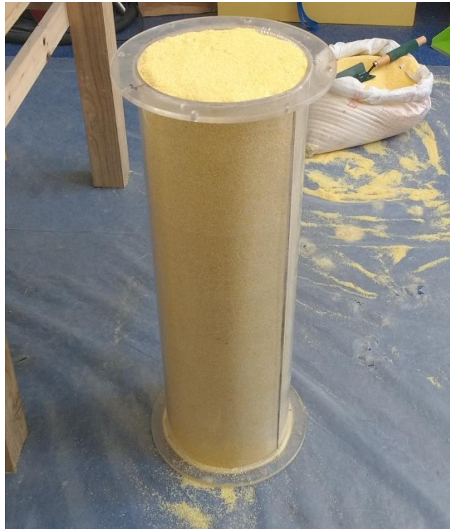
Figura 29: Ensayo de capacidad en silo Acrílico (229/755) con griz de maíz.
