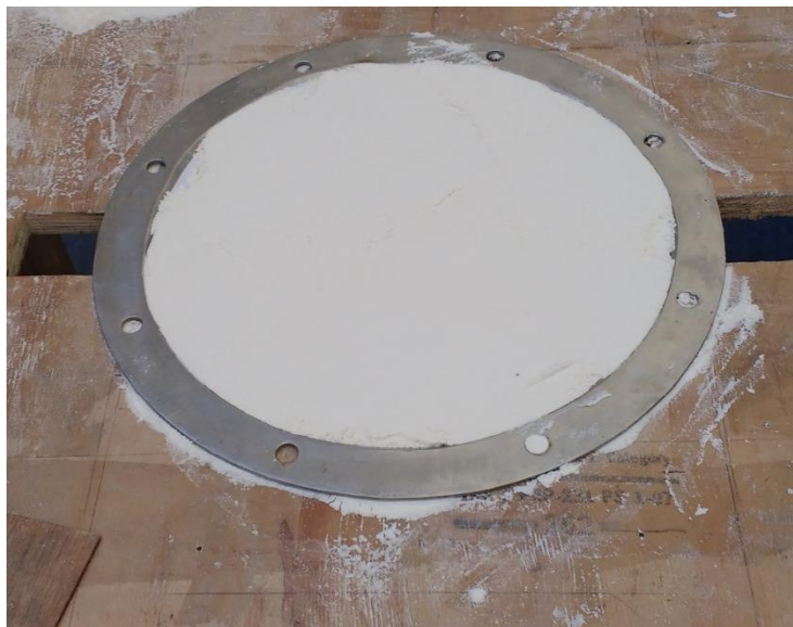
Figura 32: Ensayo de capacidad en tolva de 30° con harina.
