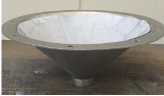
Figura 26: Tolva de 45° cubierta de papel canson.
