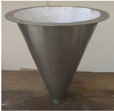
Figura 23: Tolva de 20° cubierta de papel canson
