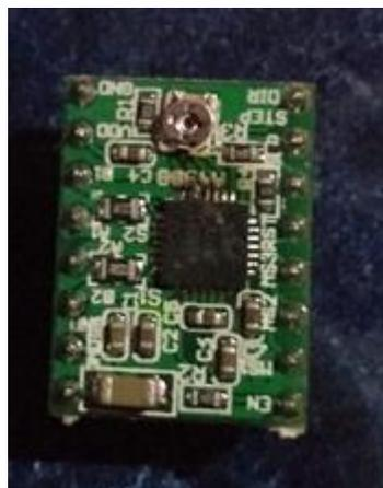
2-7 Driver A4988 para motor paso a paso bipolar.
