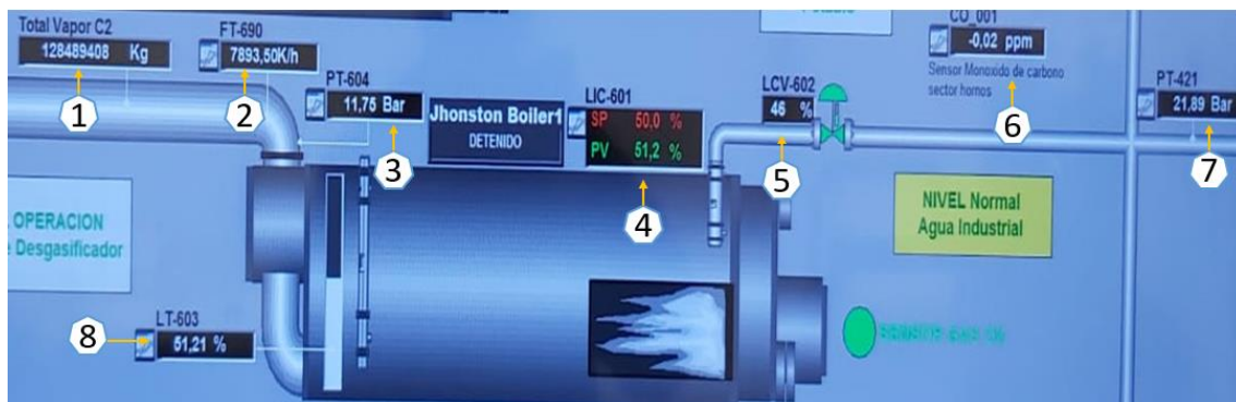
Ilustración 2- 12: Parámetros de operación de la caldera
