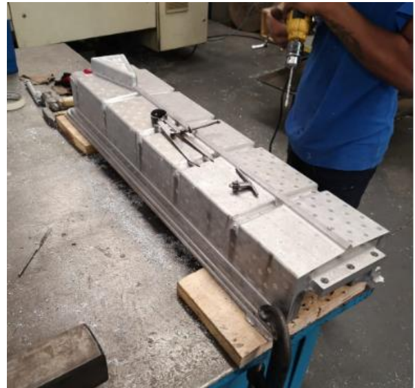
Ilustración 59: Cavidad de los pilares
