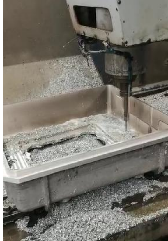
Ilustración 65: Mecanizado hembra cubierta Brilliant
