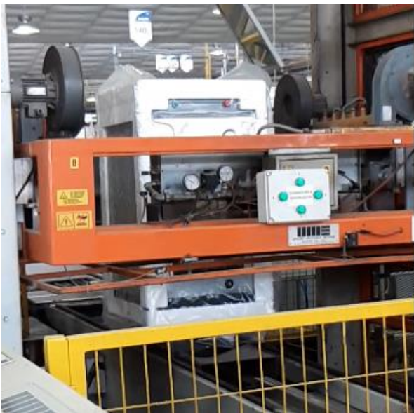
Ilustración 56: Bolsa siendo calentada en horno
