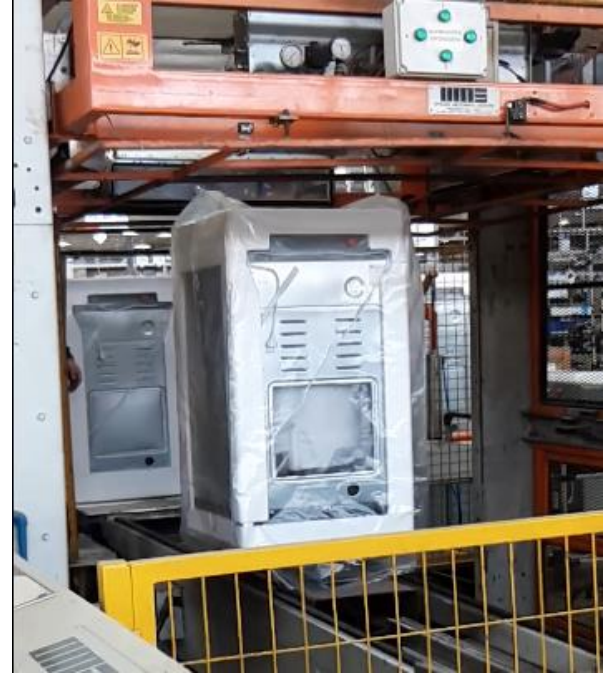
Ilustración 55: Máquina entrando en horno vertical
