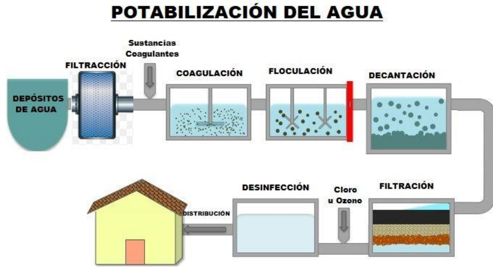
Ilustración 1 Proceso de potabilización
