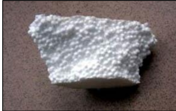
Ilustración 20. Poliestireno expandido. Unamiacor.
