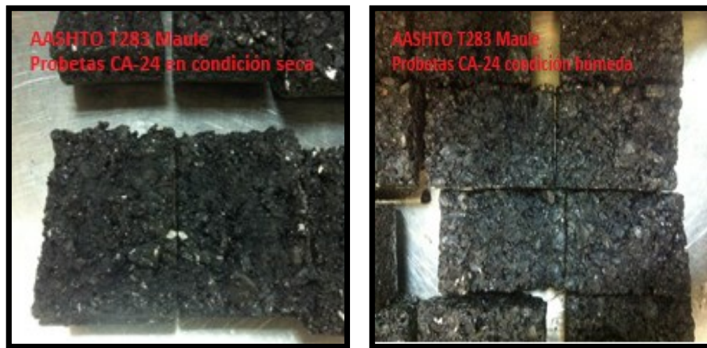
Figura 11: Fotografía de Probeta CA-24 en Condición Seca y húmeda respectivamente.
