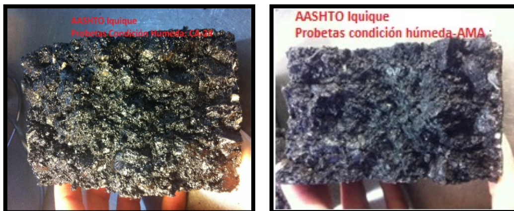
Figura 24: Fotografía de Probeta CA-24 y CA-24+AMA en condición húmeda respectivamente.
