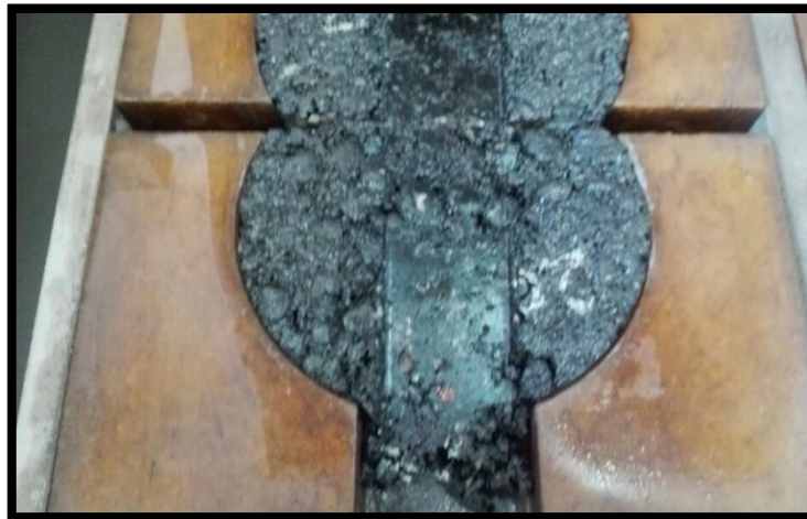
Figura 44: Fotografía de probeta luego de ser ensayada mediante rueda de Hamburgo.
