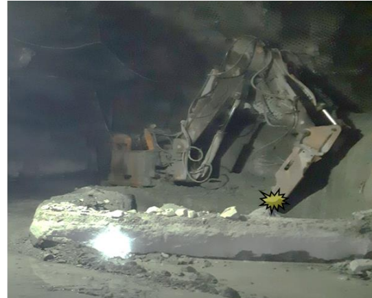
Figura 3.50. Emparrillamiento en puntos de vaciado. Ref: Muñoz R. (2024).
