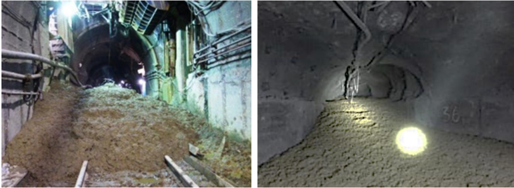
Figura 2.14. Evidencia de eventos de Bombeo Agua Barro, El Teniente. Ref: Muñoz R. (2020).
