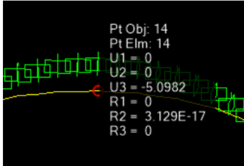
Figura 3.25. Desplazamiento del marco en la cúspide con rotulas en la unión del arco con la columna. Elaboración Propia.
