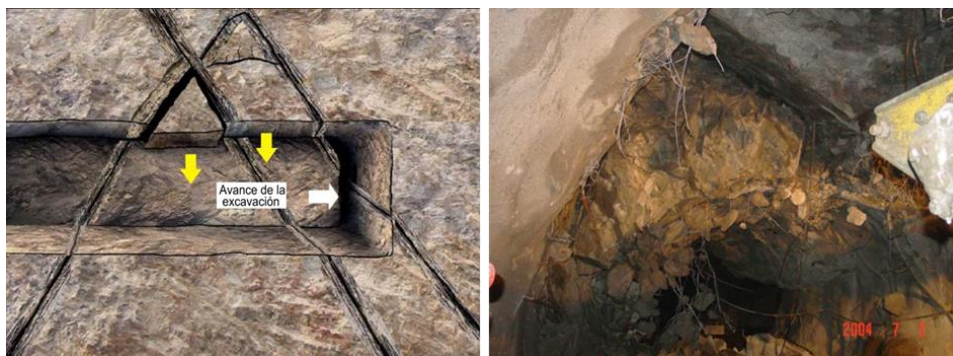
Figura 2.18. Representación esquemática de falla en la roca y desprendimiento real en el macizo rocoso. Ref: Muñoz R. (2020).
