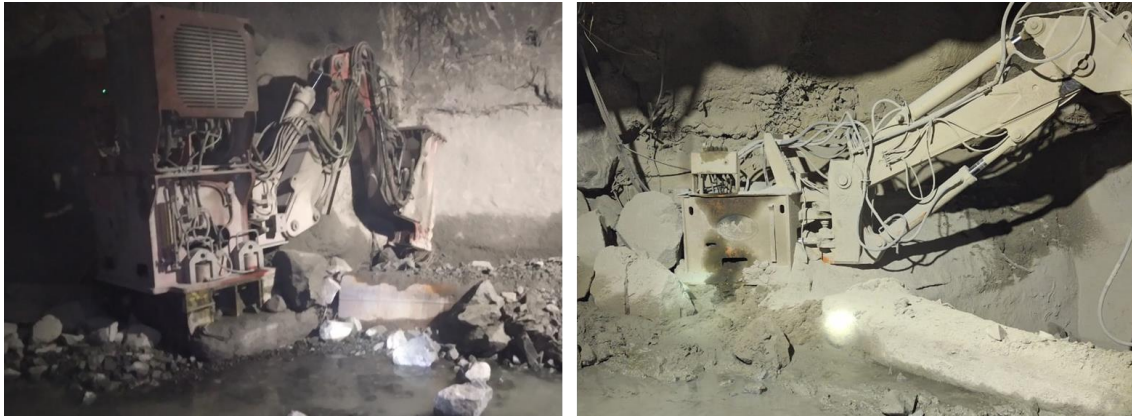
Figura 3.56. Acumulación de mineral entorno a la fundación del martillo. Ref: Muñoz R. (2020).
