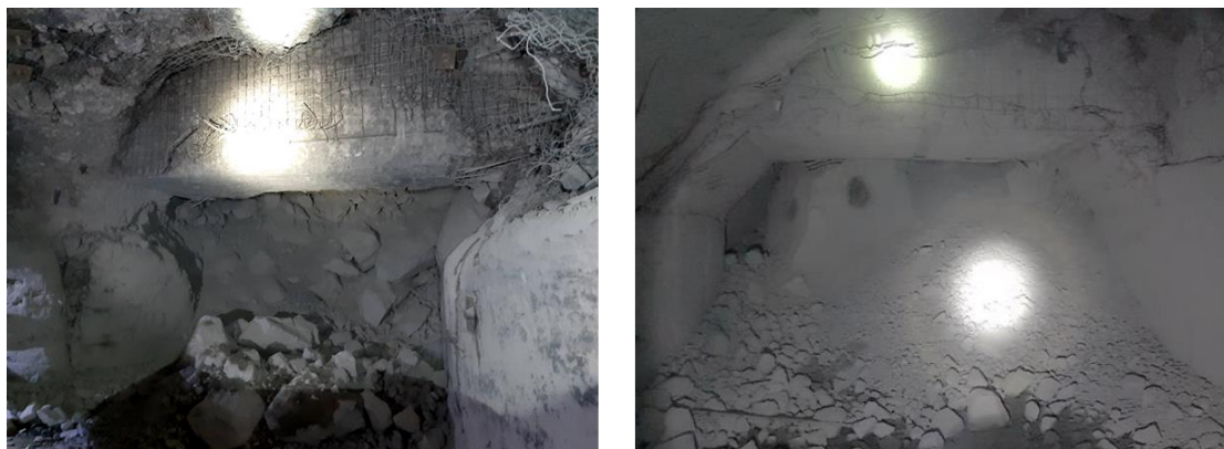
Figura 3.29 Visera de protección en punto de extracción. Ref: Muñoz R. (2024).
