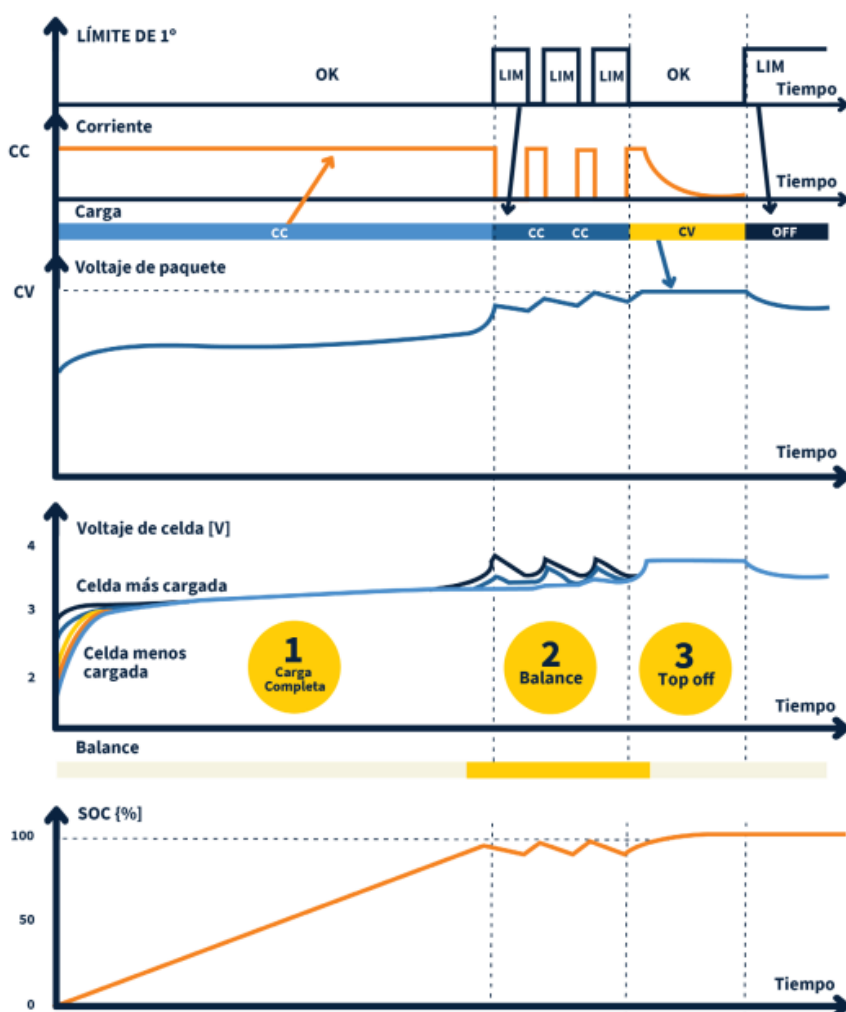
Figura 68: Ejemplo de proceso de carga por CCCV con balanceo de baterías. Fuente: (NAMA Chile. GIZ, ESS con energía solar fotovoltaica en Chile, 2020)
