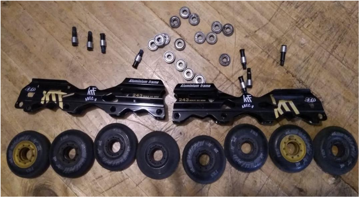
Figura 1-1. Componentes comunes de los patines en línea. De abajo hacia arriba: ruedas, frame , rodamientos y los tornillos con sus pasadores. Fuente: WhatsApp “Recorriendo Calles”
