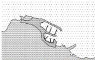
Higerillas necesita de la construcción de un molo a pesar de no recibir los trenes de olas directamente por apertura.
