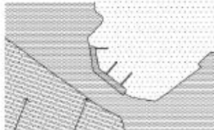
La Ex-isla Serrana, junto con el puerto industrial, protegen de los frentes de olas SW.
