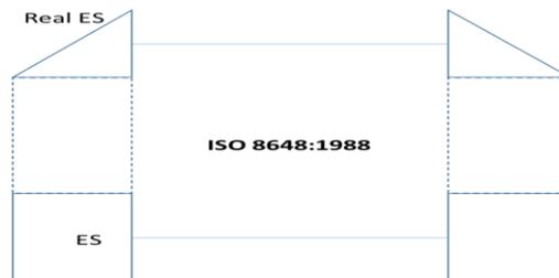
Figura 3.4.b - Diagrama de interconexión para comunicación directa entre ES (sin IS), [9.XXVIII].
