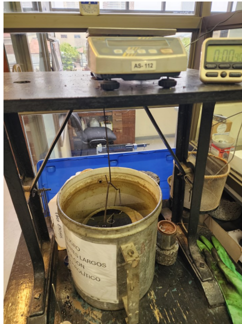
Figura 3.7: Balanza adaptada para medir probetas sumergidas. Fuente: Elaboración Propia
