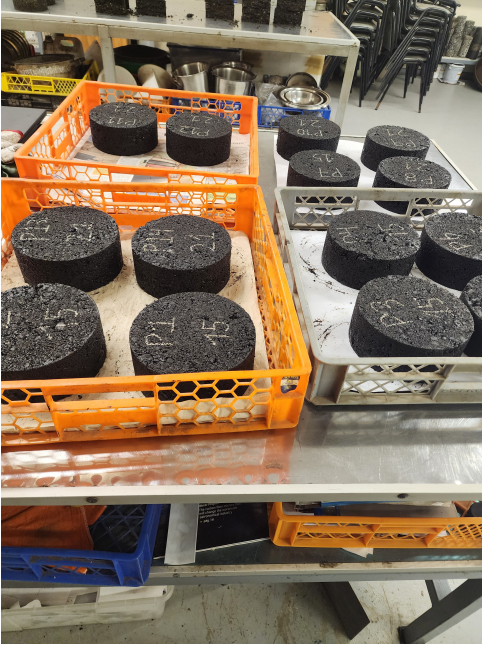
Figura 3.23: Probetas medidas y listas para ensayo. Fuente: Elaboración Propia.
