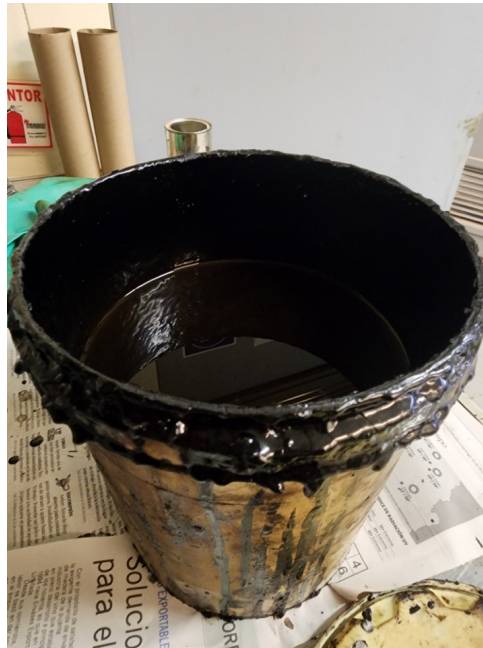
Figura 3.13: Emulsión asfáltica antes de ser utilizada. Fuente: Elaboración Propia.
