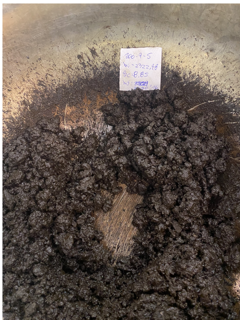
Figura 3.19: Agregado mezclado con agua y emulsión. Fuente: Elaboración Propia
