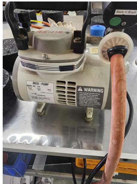
Figura 3.5: Bomba de vacío. Fuente: Elaboración Propia
