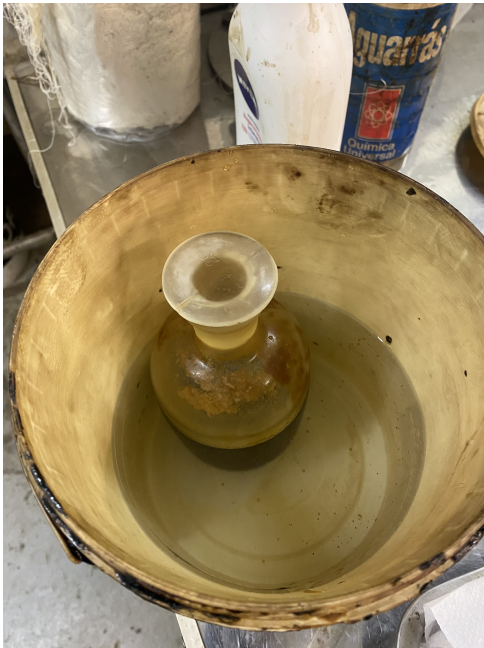
Figura 3.16: Líquido rejuvenecedor calentado a baño maría. Fuente: Elaboración Propia
