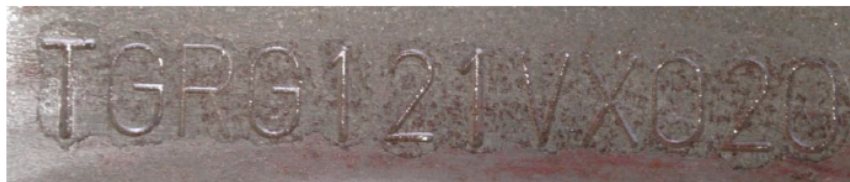
Figura 35: Marca automática sin tratamiento superficial
