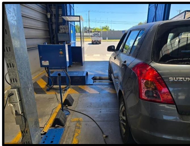
Figura 2- 3: Vehículo en prueba de procedimiento ASM.
