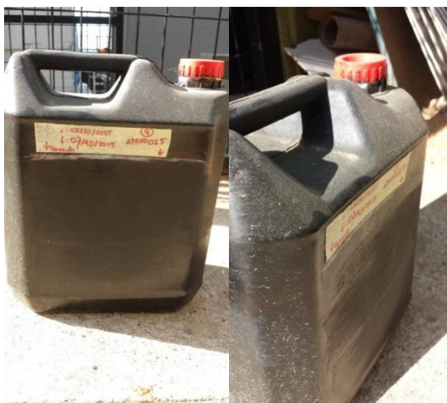
Figura 19: Deformación estructural en estanque 9 APEADO15.
