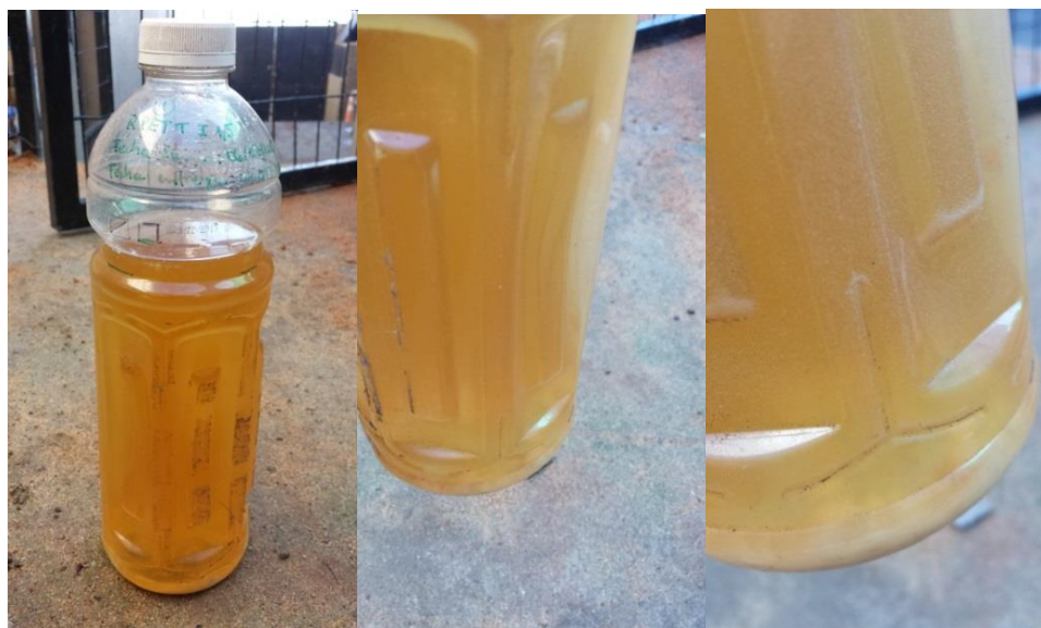
Figura 18: Deformación estructural y formación de estruvita en estanque 1 RPETTI1.5.
