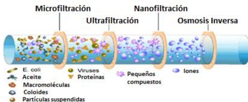
Figura 8: Capacidad de retención de partículas para distintos tratamientos de agua con utilización de membranas (SSBI USA, 2015)
