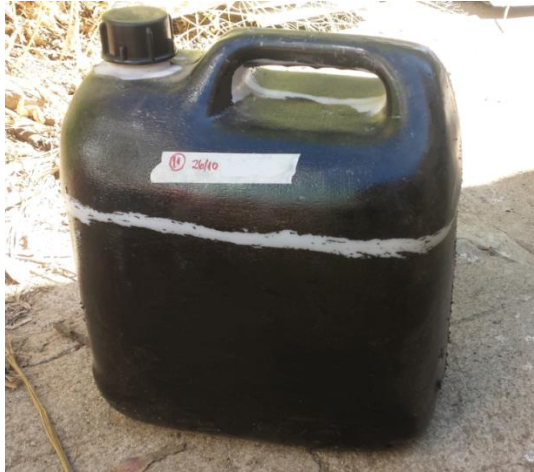
Figura 24: Estanque de acumulación a utilizar como higienizador de orina.
