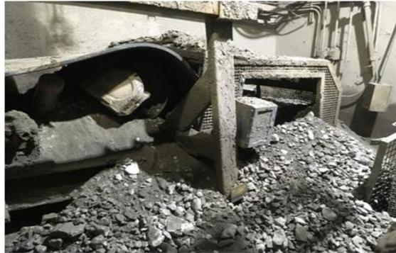
**Fig. 57:** Evidencia de la falla funcional tambor polea de cola correa alimentación SAG1 Planta molienda SAG Los Bronces. (fuente: creación propia)
