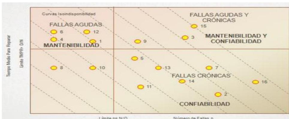
Fig. 29: ejemplo de diagrama Jack Knife
