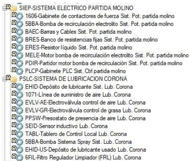
Fig. 53: jerarquía de componentes sistema eléctrico de puesta en marcha y sistema lubricación corona, Molino SAG 1 Planta Los Bronces (fuente: creación propia)
