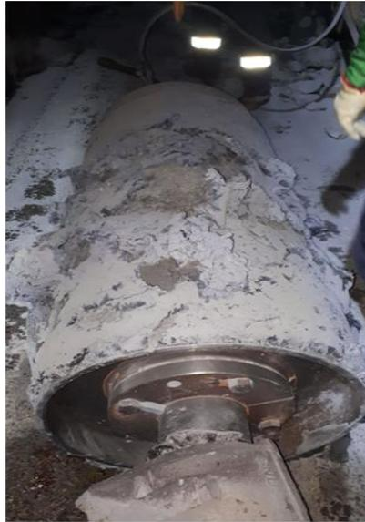
Fig. 58: Evidencia de la falla funcional revestimiento y descanso polea de cola correa alimentación SAG1 Planta molienda SAG Los Bronces. (fuente: creación propia)
