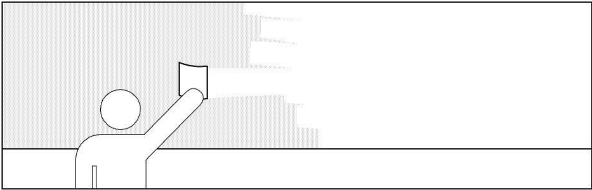
Imagen 3-10: Aplicación de Chilco Dry, 1er Paso.
