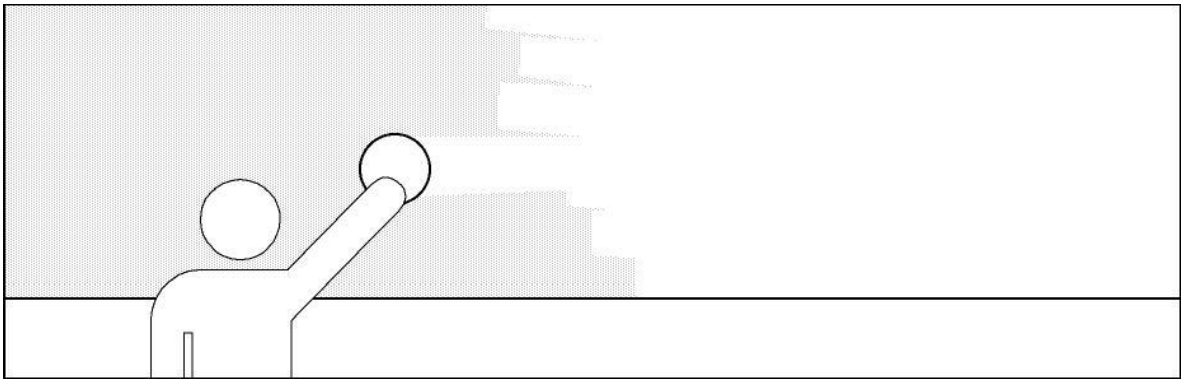
Imagen 3-11: Aplicación de Chilco Dry, 2do Paso.
