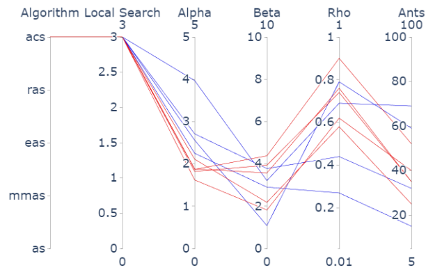
Figura 39: Gráfico de coordenadas paralelas de configuraciones sobrevivientes al final de 1 ejecución de irace (líneas en rojo) y clirace (líneas en azul) sintonizando el algoritmo ACOTSP con el set de instancias TSP-1000/3000 con 1.000 evaluaciones
