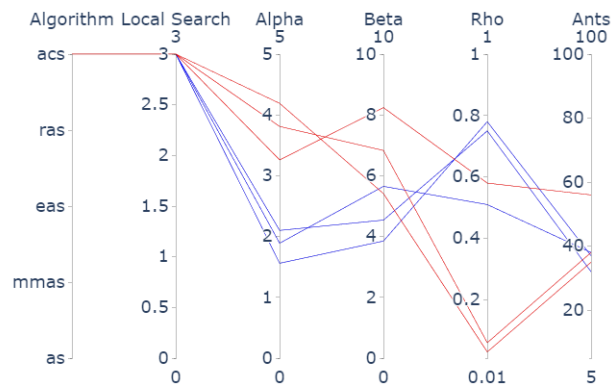
Figura 44: Gráfico de coordenadas paralelas de configuraciones sobrevivientes al final de 1 ejecución de irace (líneas en rojo) y clirace (líneas en azul) sintonizando el algoritmo ACOTSP con el set de instancias TSP-1000/3000 con 10.000 evaluaciones
