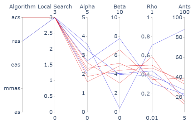
Figura 40: Gráfico de coordenadas paralelas de configuraciones sobrevivientes al final de 1 ejecución de irace (líneas en rojo) y clirace (líneas en azul) sintonizando el algoritmo ACOTSP con el set de instancias TSP-1000/3000 con 1.000 evaluaciones
