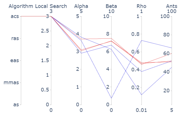
Figura 42: Gráfico de coordenadas paralelas de configuraciones sobrevivientes al final de 1 ejecución de irace (líneas en rojo) y clirace (líneas en azul) sintonizando el algoritmo ACOTSP con el set de instancias TSP-1000/3000 con 10.000 evaluaciones
