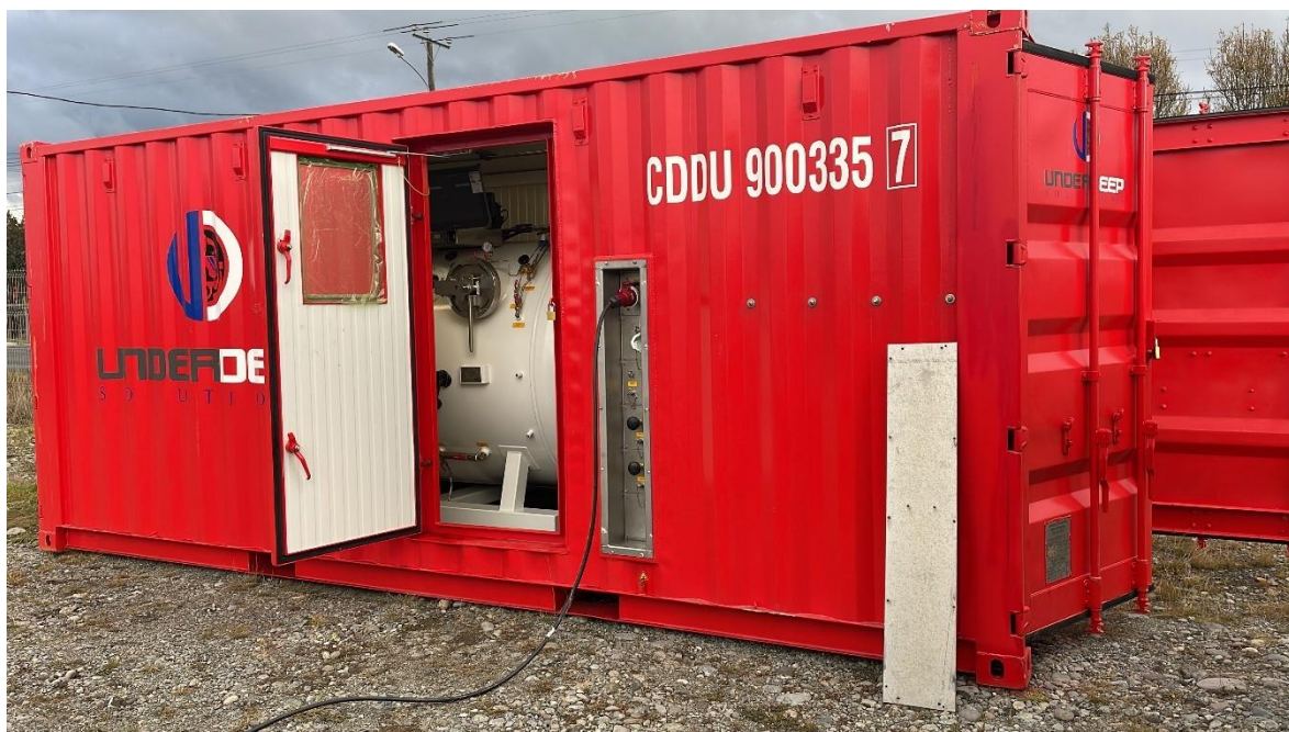
Ilustración 3- 20: Cámara Hiperbárica containerizada POMMEC DDC-1600.
