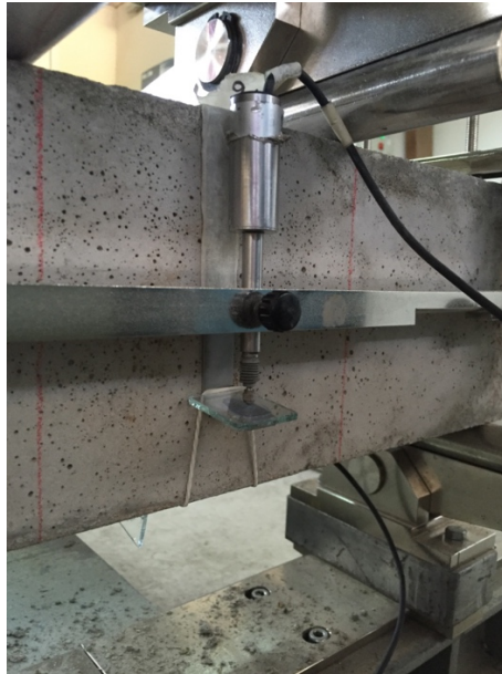
FIG.11: TRANSDUCTOR MEDIDOR DE DEFLEXIÓN
