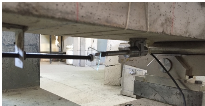
FIG.12: TRANSDUCTOR MEDIDOR DE APERTURA DE FISURA
