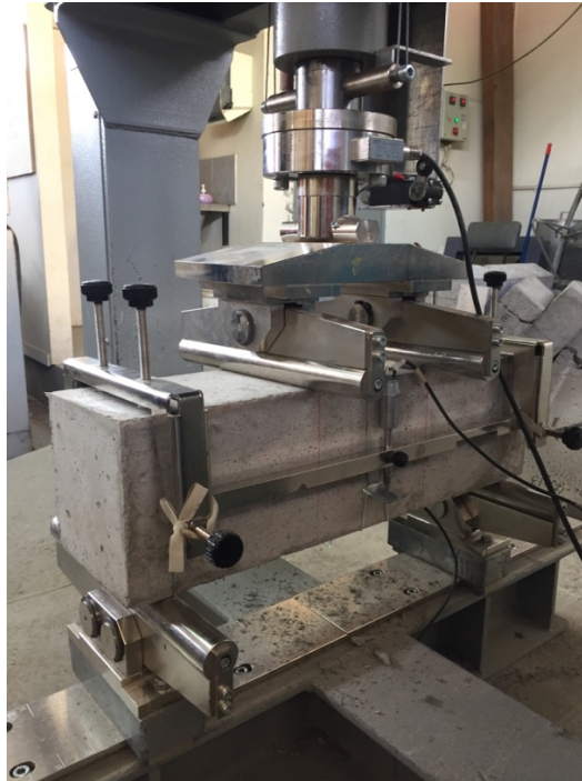
FIG.10: EJECUCIÓN ENSAYO ASTM C1609
