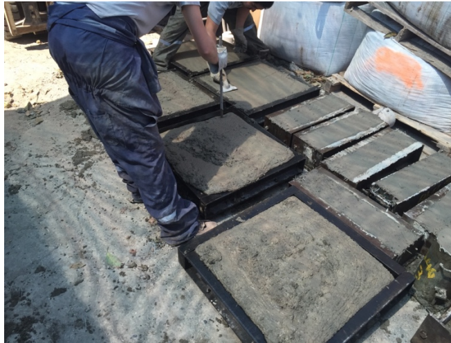
FIG 16: CONFECCIÓN DE PROBETAS
