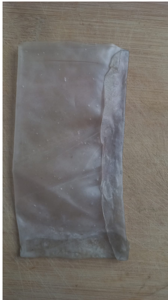
Figura 3.41: Termo sellado de biofilm de almidón de papa, Elaboración Propia
