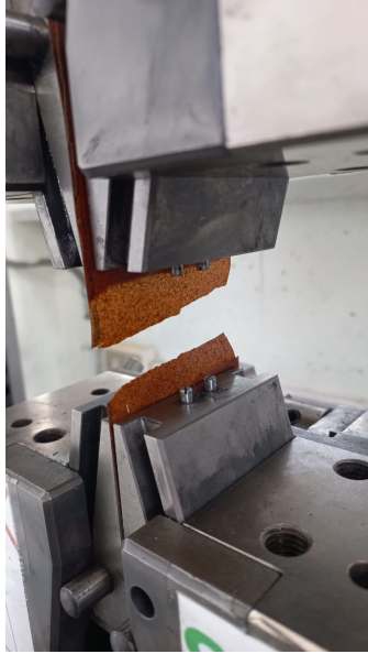
Figura 3.27: Rotura probeta de almidón de palta, Elaboración Propia
