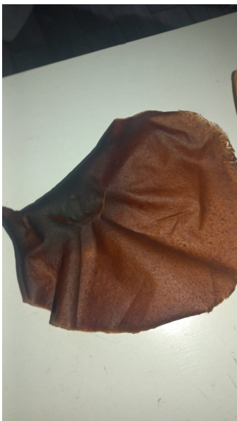
Figura 3.11: Contracción irregular del material, Elaboración propia
