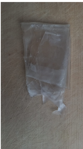
Figura 3.43: Unión por pegamento de biofilm de almidón de papa. Elaboración Propia
