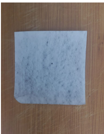
Figura 3.29: Biofilm almidón de palta superficie rugosa, Elaboración Propia
