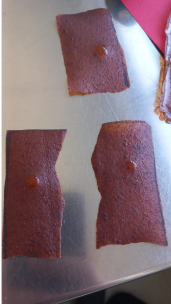
Figura 3.53: Comparacion de las tres pruebas del biofilm de almidon de palta por la cara rugosa, Elaboración Propia
