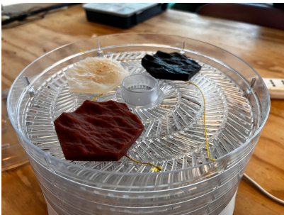
Figura 1.4: Bioplasticos con agar y residuos vegetales, Elaboración Propia.
