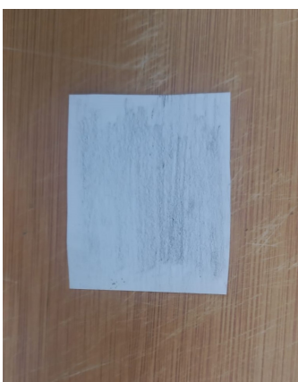
Figura 3.30: Biofilm almidón de palta superficie lisa, Elaboración Propia
