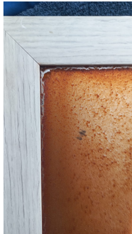
Figura 3.15: Contracción de material, Elaboración Propia
