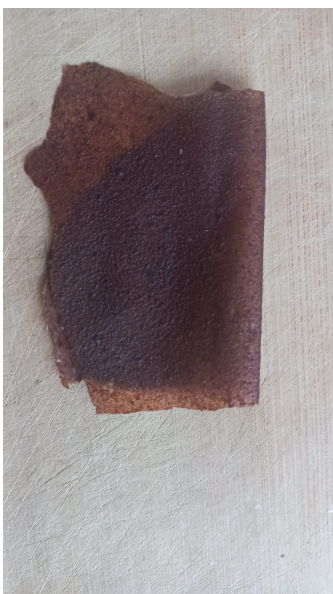
Figura 3.42: Unión por pegamento de biofilm de almidón extraído. Elaboración Propia
