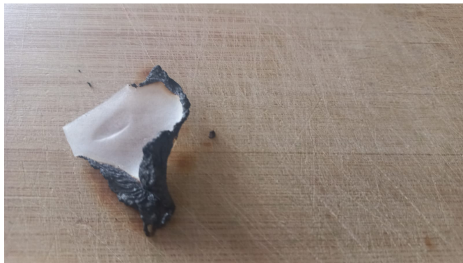
Figura 3.33: Prueba biofilm de almidón de papa, Elaboración Propia
