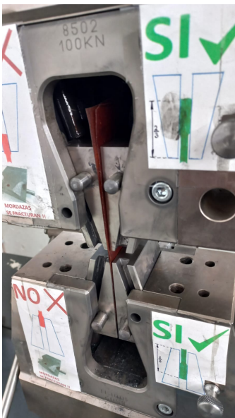
Figura 3.24: Montaje probeta de almidón de palta, Elaboración Propia
