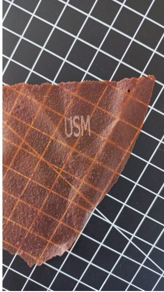
Figura 3.35: Grabado láser en la superficie del material, Elaboración Propia
