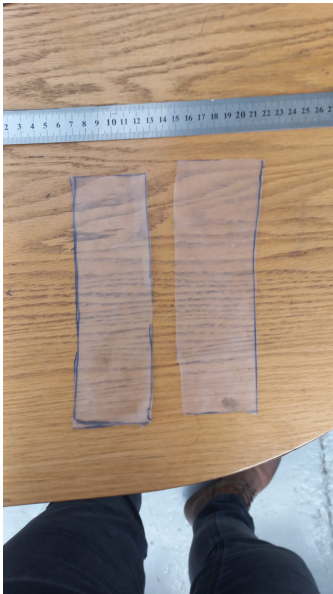
Figura 3.23: Probetas a base almidón de papa, Elaboración propia
