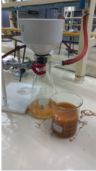
Figura 1.16: Separación con Matraz de kitasato, Elaboración Propia
