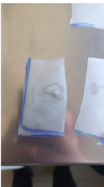
Figura 3.52: Muestra de biofilm de almidón de papa con exposición de 20 segundos, Elaboración Propia
