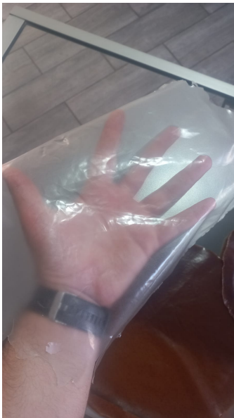
Figura 3.19: Biofilm de Chuño, Elaboración Propia
