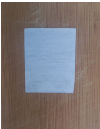
Figura 3.31: Biofilm almidón de papa, Elaboración Propia
