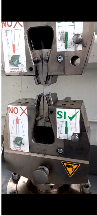
Figura 3.25: Montaje probeta de almidón de papa, Elaboración Propia
