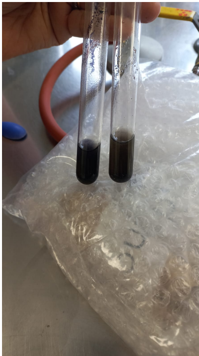
Figura 3.5: Prueba de lugol, Elaboración Propia
