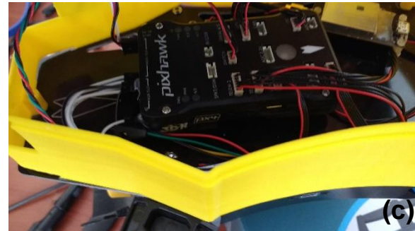
FIGURA 21: Primer prototipo de extensión para dron Iris+. (a) Proceso impresión de la pieza (b) Extensión instalada en el dron (c) Revisión de calces e interferencias.
