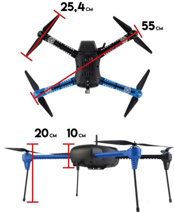
FIGURA 10: Dimensiones generales dron IRIS+.
