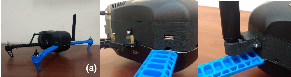
FIGURA 28 :Dron Iris+ modificado. (a) dron ensamblado (b) RaspiCam y puerto USB (c) Antena Wifi.
