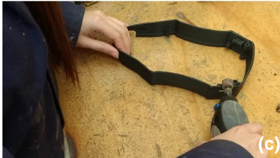
FIGURA 25: Piezas impresas. (a) Distintos prototipos y piezas fallidas (b) pieza impresa correctamente (c) pulido de piezas.
