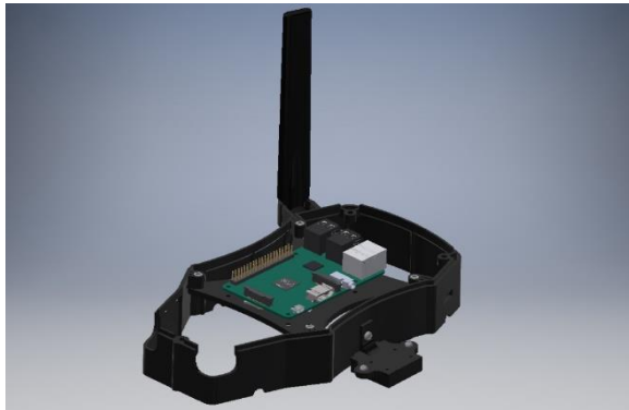
FIGURA 18: Modelos 3D de soportes de los dispositivos añadidos al dron. (a) soporte RaspberryPi (b) carcasa Raspicam (c) soporte antena Wifi.
