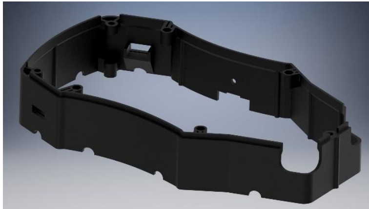
FIGURA 17: Modelo 3D de la extensión final para el dron IRIS+.
