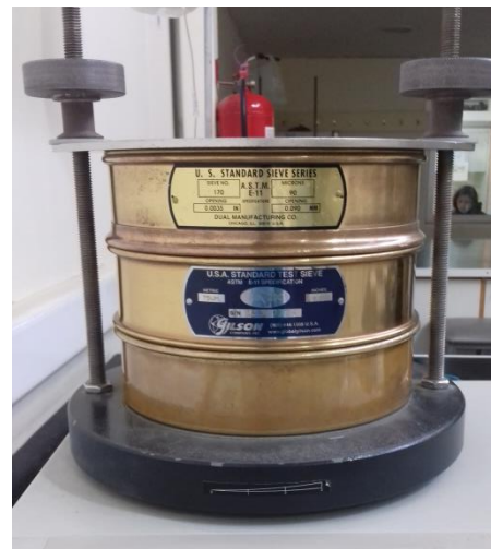
Fuente: Imagen obtenida por alumna Figura 2-4, muestra la serie #170, #200 y fondo Laboratorio de Metalurgia USM Sede Viña del Mar.
