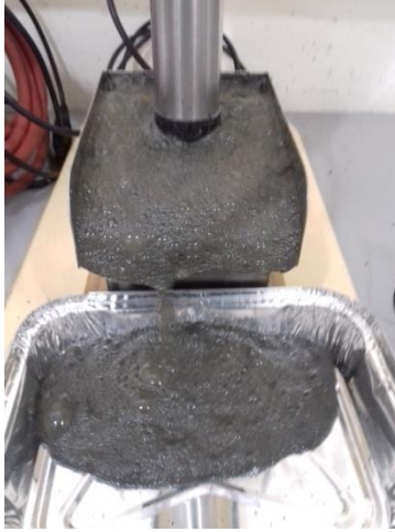
Figura 2-10, proceso de flotación, concentrado húmedo.
