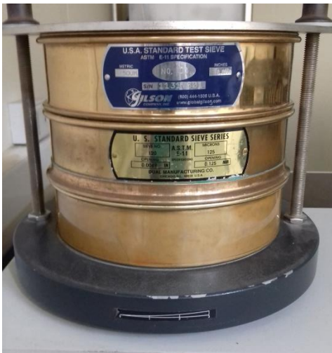
Fuente: Imagen obtenida por alumna Figura 2-3, muestra la serie #100, #120 y fondo en Laboratorio de Metalurgia USM Sede Viña del Mar.
