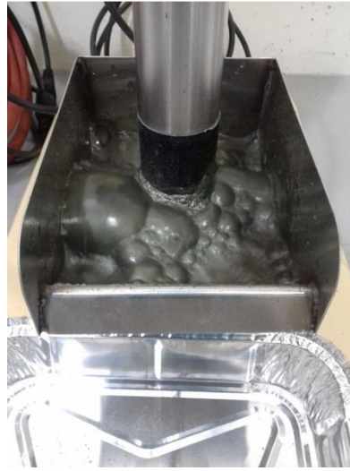
Fuente: Imagen obtenida por alumna Figura 2-8, celda de flotación con mineral y agua.
