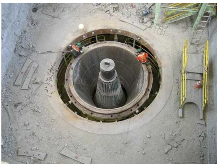
Figura 7.Chancador Primario Los Bronces
