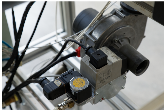
Fig. 2.16: Conjunto Soplador y Monoblock de Gas.
