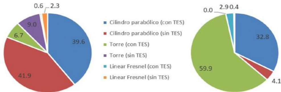
Figura 1.2: Capacidad porcentual de las CSP en operación (izquierda) y en construcción o desarrollo (derecha). (1)
